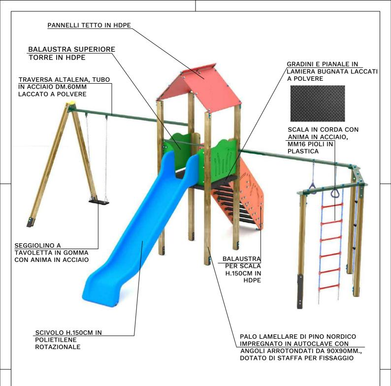
TUTTI GLI ELEMENTI DI FISSAGGIO, VITI, DADI, RONDELLE ECC. SONO IN ACCIAIO ZINCATO E PROTETTI DA GHIERE E TAPPI IN POLIETILENE.
